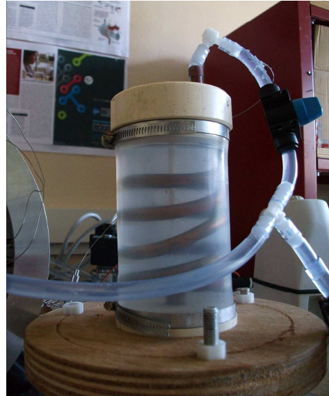
FIGURE III.23- Vue détaillée du serpentin en cuivre et vue d'ensemble de l'échangeur connecté au prototype.
