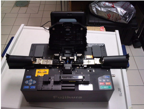
FIGURE 1.19 – L'image de la soudeuse Fujikura FSM-45PM-LDF.
