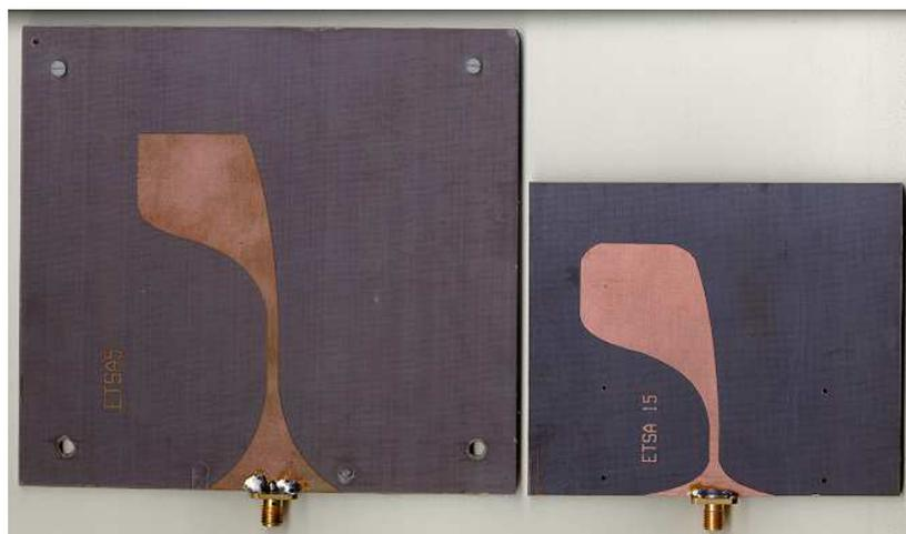
**Figure 27 : Formes géométriques des antennes initiales (à gauche) et optimisées (à droite)**
