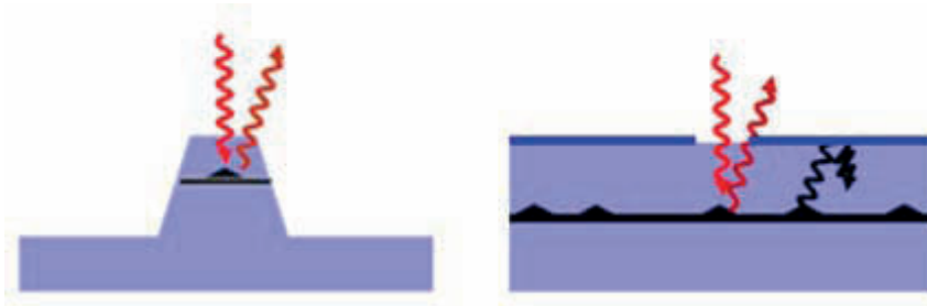
Figure 2.13. Deux techniques d'isolation spatiale de boîtes (a) par la gravure d'un mesa et (b) par une ouverture submicronique dans un masque métallique. L'excitation du laser est en rouge et la luminescence des boîtes isolées spatialement est représentée en magenta. L'émission des boîtes en dehors de l'ouverture (en noire) est bloquée par le masque.
