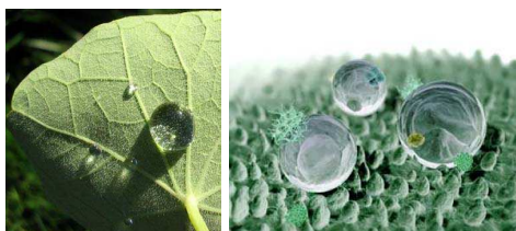
Fig.2 : Influence d'un matériau naturel nanostructuré en surface sur les propriétés d'hydrophobicité [6].
