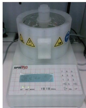
Fig.9 : Technique de Spin-coating pour déposer la solution rouge sur le substrat de verre (Spin-coater type spin150).
