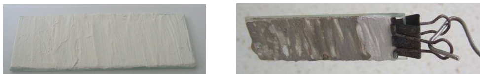
Fig.3 : A gauche : application du nitrure de bore sur la face avant échange, à droite : résultat après échange ionique.
