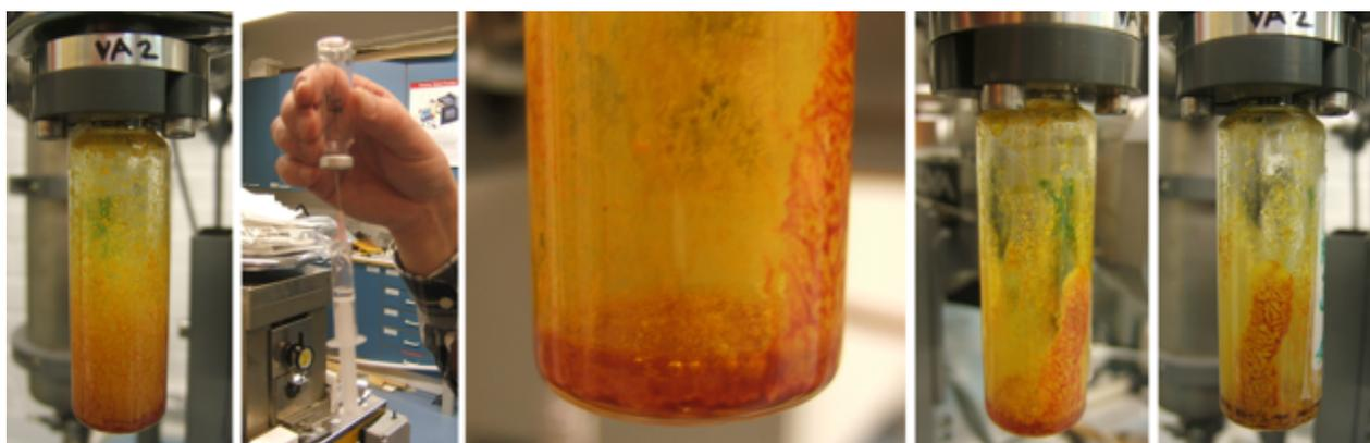
FIGURE 5.19 – Test de  $Cp_2Ti(CH_3)_2$  dans du liquide ionique : Produit sec ; Liquide ionique dans le seringue et 3 vues du  $Cp_2Ti(CH_3)_2$  du resolubilisé dans du liquide ionique. On constate des éclaboussures dues à des bulles dans le liquide ionique. / Test of  $Cp_2Ti(CH_3)_2$  in ionic liquid : Dry product ; Ionic liquid in syringe ; 3 different views of  $Cp_2Ti(CH_3)_2$  diluted in ionic liquid. Bubbles appeared in the ionic liquid.
