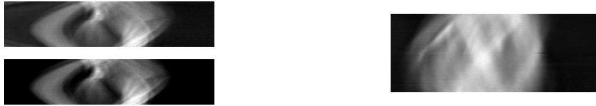
FIG. 5.37: Exemples de sinogrammes des séries 20090530–04 (en haut, à gauche) et 20091107–08 (à droite). Ces deux sinogrammes seront utilisés pour l'étude paramétrique permettant de déterminer la valeur du paramètre de régularisation \mu . Toutefois, dans la partie gauche du sinogramme extrait de la série 20090530–04, on discerne une portion de fuseau sinusoïdal qui correspond à un objet partiellement contenu sur une partie des projections. Il est supprimé manuellement pour l'étude paramétrique, qui porte donc sur le sinogramme présenté en bas, à gauche.
