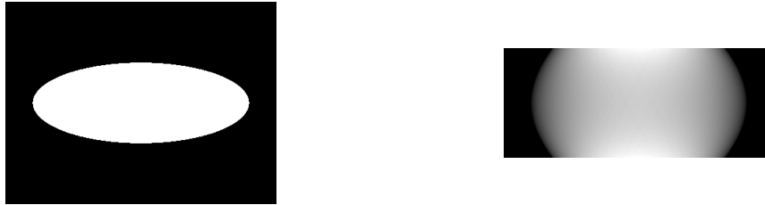
FIG. 5.32: A gauche, la tranche de l'objet fictif considéré, à droite, le sinogramme obtenu pour -40^\circ \leq \theta \leq 40^\circ , \Delta\theta = 0.5^\circ .
