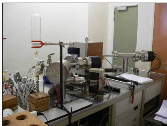
Fig.II-8 : Spectromètre de masse de l'Université Claude Bernard Lyon I utilisé lors de cette étude.
