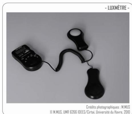
La luminosité d'un espace se mesure en « lux » à l'aide d'un luxmètre [Photo 5-2]. Il capte et mesure la lumière en un point donné.
