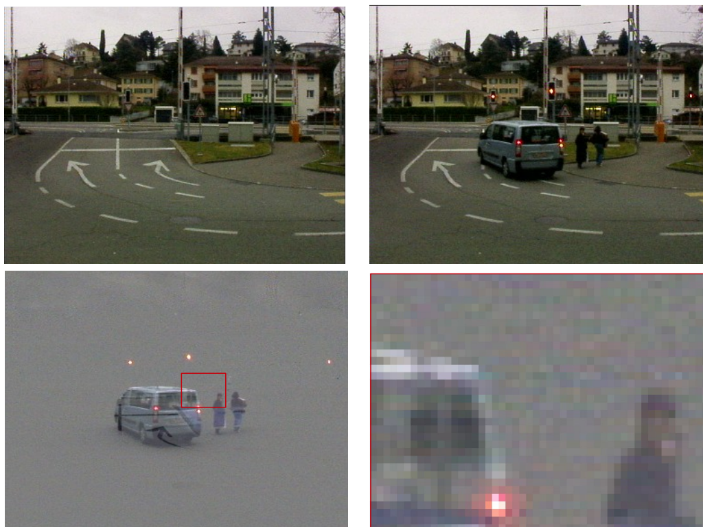
FIGURE 3.4 – Exemple d’un objet approximé par analyse en composantes indépendantes. Les images en haut à gauche et à droite correspondent à l’image du fond et une image de la séquence, respectivement. L’image en bas à gauche est la composante de l’objet estimée à partir de l’ACI appliquée sur les deux images en haut à gauche et à droite. En voyant de près une petite région (rectangle rouge), nous remarquons que l’objet est mis en valeur par rapport à l’arrière-plan. La classification fond / objet n’est pas tout à fait évidente puisque le fond est bruité.
