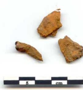
Figure 9 : Ecailles d'oxyde prélevées sur l'échantillon GL94-102.
