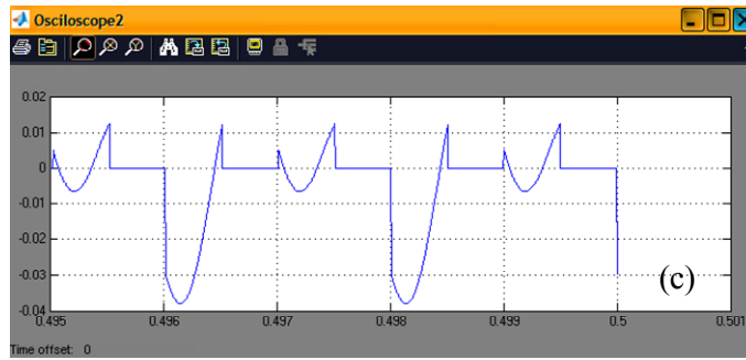
Figure 2.8 Résultats de simulation dans le cas V_{b0} = 3 \text{ V} : sorties du modulateur (a), du filtre passe-bande (b) et du comparateur de phase.
