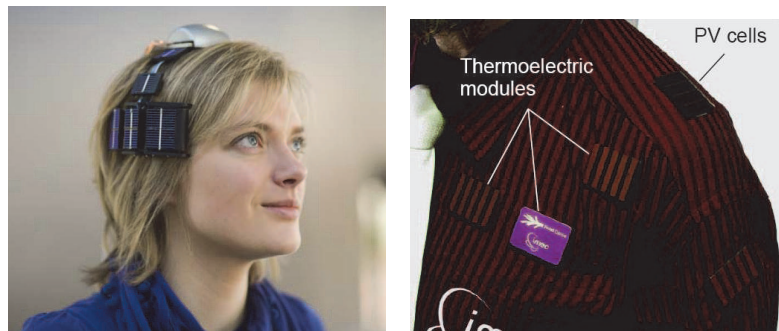
(a) Générateur hybride pour l'alimentation d'un EEG [Van Bavel08] (b) Générateur hybride pour l'alimentation d'un ECG [Leonov09a]
