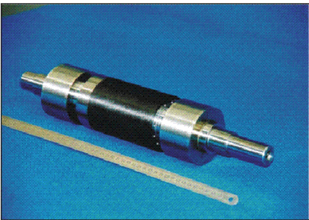
(a) Rotor avant le test, ( \Omega = 3,5 \cdot 10^4 \text{tr/min} )
