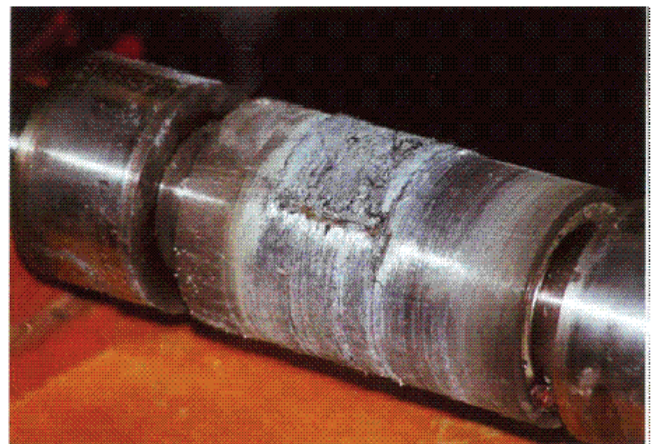
(b) Rotor après le test, ( \Omega = 3,5 \cdot 10^4 \text{tr/min} )
