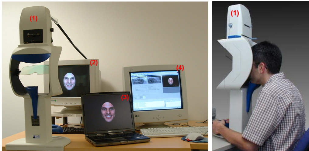
Figure 4.9 : (1) oculomètre, (2) écran de présentation des images, (3) ordinateur contrôlant la projection des stimuli via le logiciel Presentation , et (4) ordinateur relié à l'oculomètre, permettant le recueil des enregistrements binoculaires via le logiciel iViewX Hi-Speed de SMI qui décompose le signal de position des yeux en événements (saccades, fixations, clignements).
