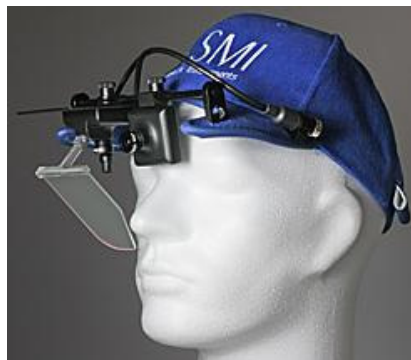
Figure 4.10 : Cet oculomètre portable monoculaire ( iViewX HED de SMI) est constitué d'une casquette sur laquelle sont placés un petit miroir en dessous de l'œil, et deux caméras, l'une mesurant le reflet infrarouge et l'autre filmant la scène devant le sujet. La fréquence d'échantillonnage est de 200 Hz et la résolution spatiale de 0,5^\circ à 1^\circ .
