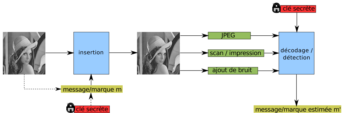
FIGURE 1.1 – Schéma de tatouage : schéma général. L'insertion et le décodage (ou la détection) sont soumis à l'utilisation d'une clé secrète. Le contenu tatoué peut subir des attaques de robustesse comme une compression, une impression suivie d'une acquisition (via un scanner) ou, en toute généralité, un ajout de bruit.
