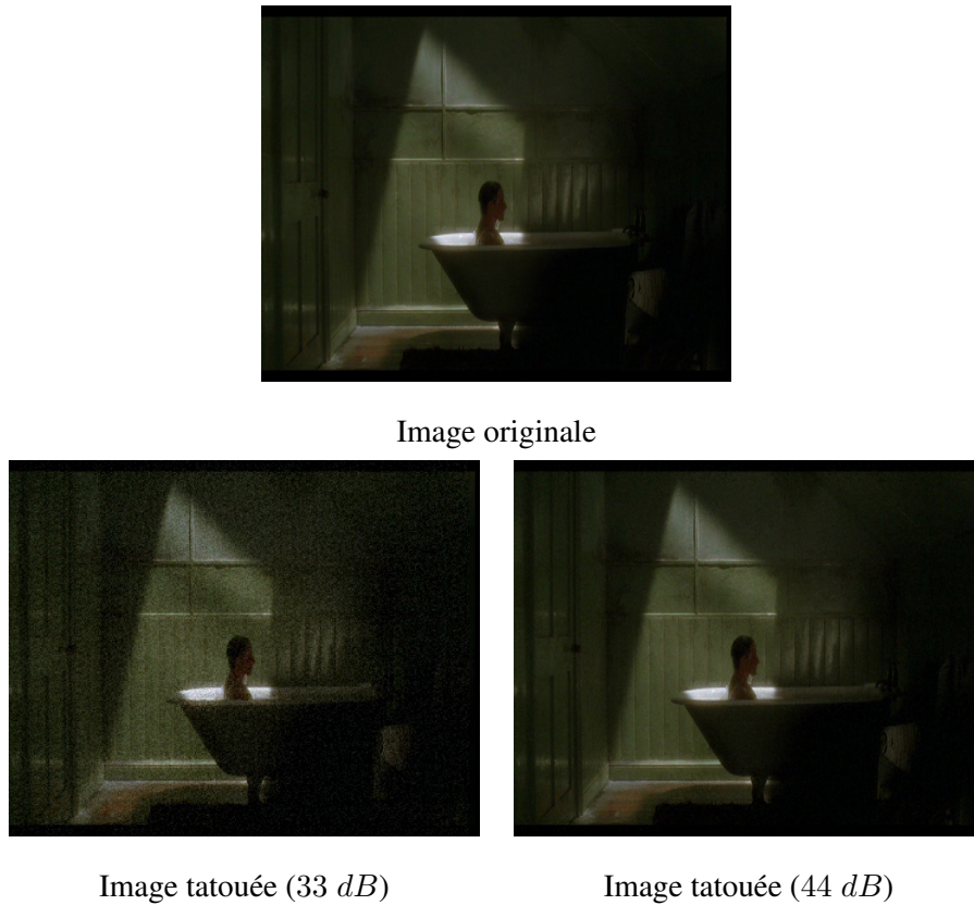
FIGURE 5.5 – Image originale et images obtenues après tatouage dans le domaine de la luminance pour des PSNR par tuile de 33 dB et 44 dB. Modulation : ISS.
