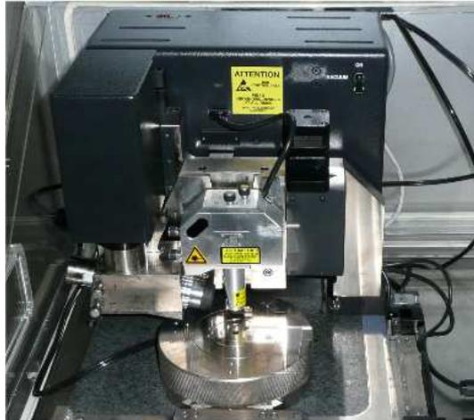
Fig. 2.15 : Photographie du microscope Dimension 3100 de Veeco
