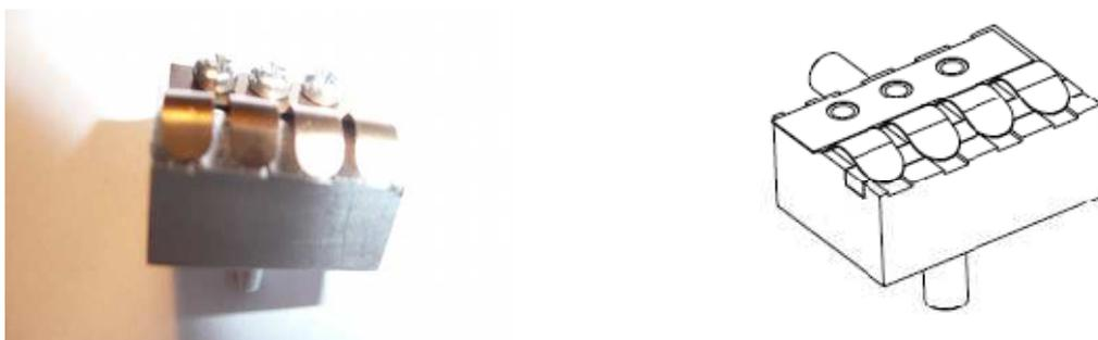
**Figure 2.41 :** Porte pointe développé pour l'observation MEB
