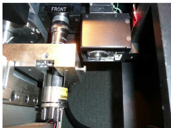
Figure 2.46 : Montage AFM-nanoindenteur
