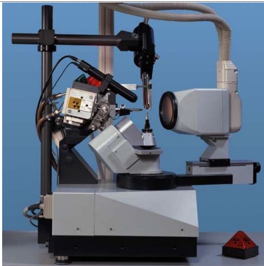
figure 6: diffractomètre Nonius Kappa-CCD, présenté ici avec un système de réfrigération Oxford Cryostream
