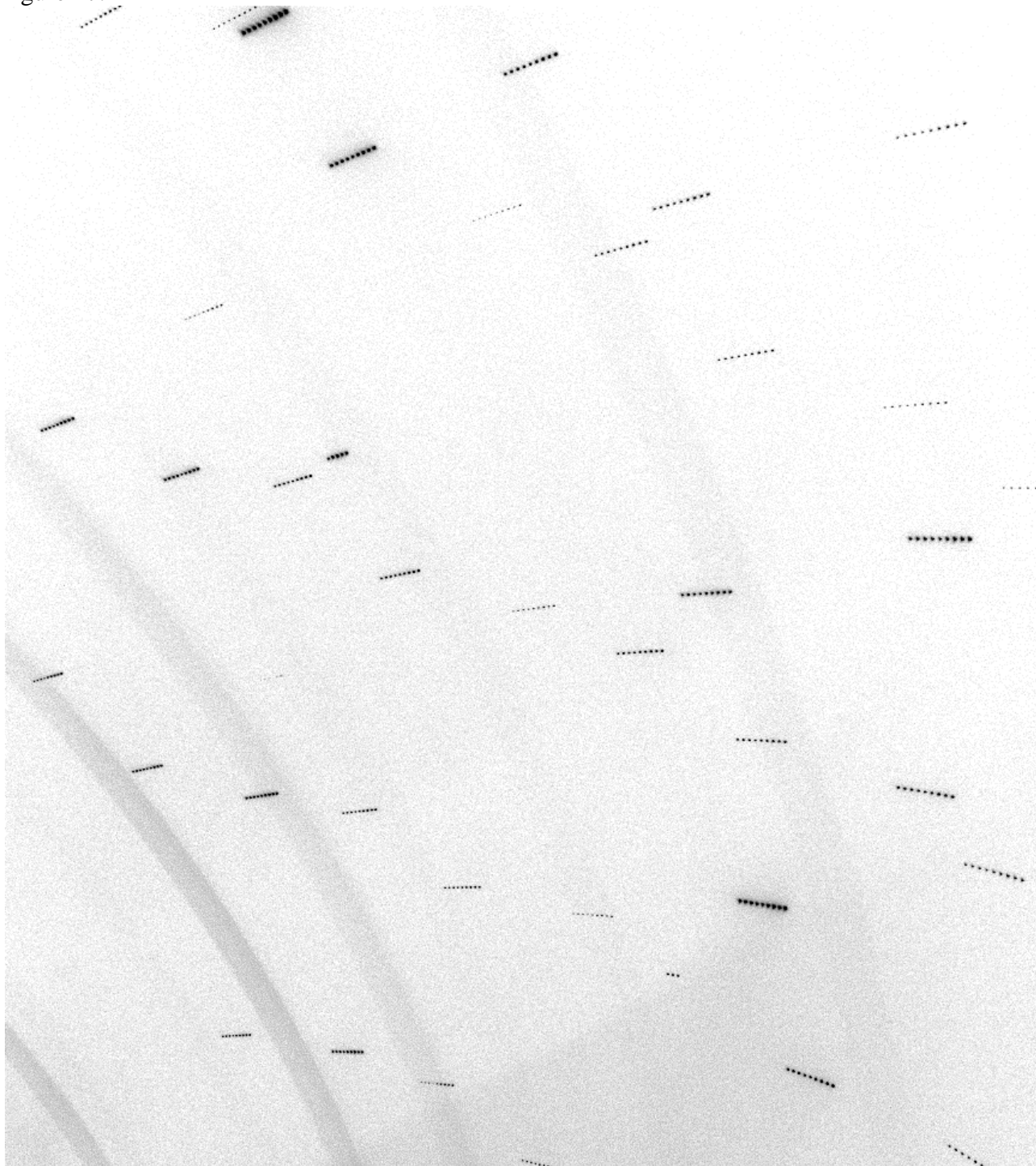
figure 16 : cliché de diffraction obtenu en mode SMAD, avec 9 longueurs d'onde. Le cliché équivalent en mode DDAFS est présenté dans la figure 11.
