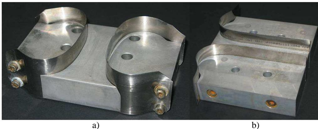
Figure 23: a) Emporte-pièce pour éprouvette radiale sans tube intestinal et orthoradiale
