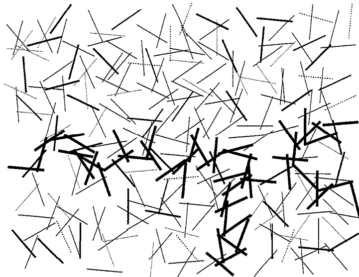
Figure I.21 : Illustration schématique du cas d'un réseau de fractures bien connectées ayant une large distribution d'ouvertures. L'écoulement principal aurait lieu dans un sous-réseau de fractures très conductrices (traits épais), proche du seuil de percolation, modifié d'après Charlaix et al. [1987].
