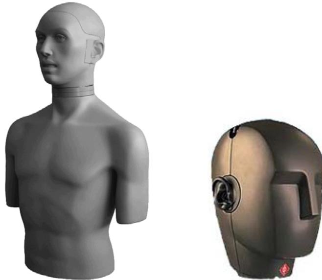
Fig. I-10 : Exemple de têtes binaurales utilisée pour la technique binaurale
