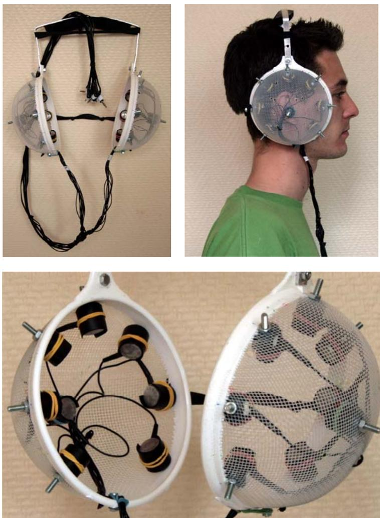
Fig. V-2 : Prototype modulaire de casque multi-transducteurs
