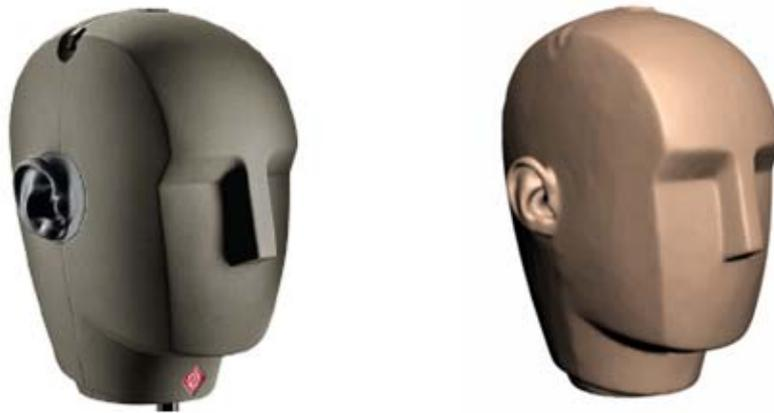
Fig. III-17 : Tête acoustique Neumann KU-100 et modèle numérique dérivé
