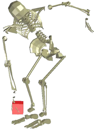
Figure 3.2 – Réalisation d'une tâche d'atteinte pour la main droite en conservant l'équilibre statique, c'est-à-dire, les deux pieds au sol et le centre de masse projeté au centre de son polygone de sustentation.
