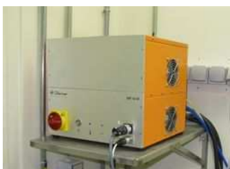
Figure 5-3: Générateur VITI - 24 kW - Fréquence : 23 kHz
