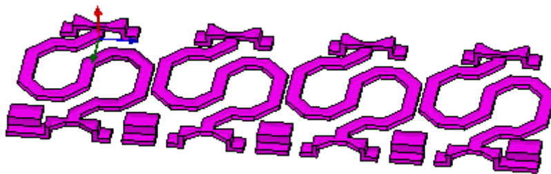
Figure IV - 40 : Réseau d'inductances distribué le long du drain du transistor
