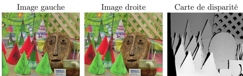
FIGURE 2.3: Couple d'images et carte de disparité. Sur la carte de disparité, les pixels noirs sont les pixels dont le correspondant est occulté ou inconnu.
