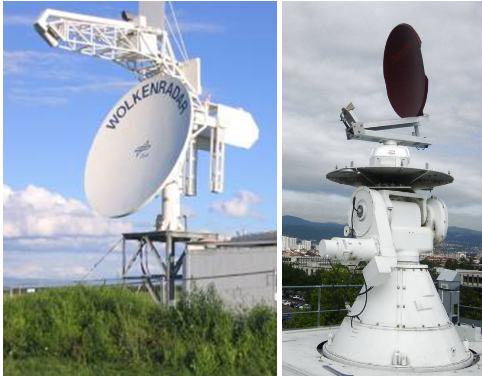
FIG. 3.2 – Radar Poldirad du Deutsches Zentrum für Luft und Raumfahrt (à gauche) et radar en bande X du Laboratoire de Météorologie Physique (à droite)
