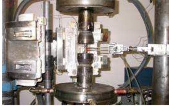
Figure II-13: Four + extensomètre à tiges de quartz, pour essais sous Air à 300°C au Creusot
