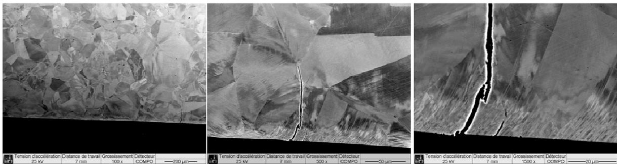
Figure IV-53: Exemple d'une fissure de plus de 100μm de profondeur interceptée sur une coupe longitudinale de l'éprouvette NPC07A testée 300 cycles sous REP à 300°C ;  $\Delta\epsilon/2 = \pm 0.6\%$  et  $d\epsilon/dt = 0.001\%/s$
