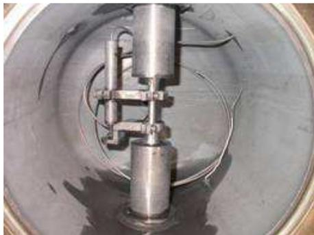
Figure II-14: Autoclave + capteur LVDT pour essais REP au Creusot
