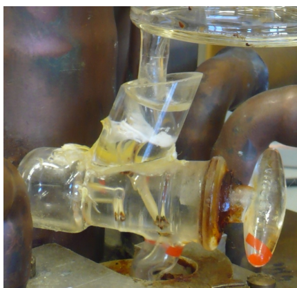
FIGURE 2.7 – Réparation du col de la cellule cassée au dessus du robinet R_c .
