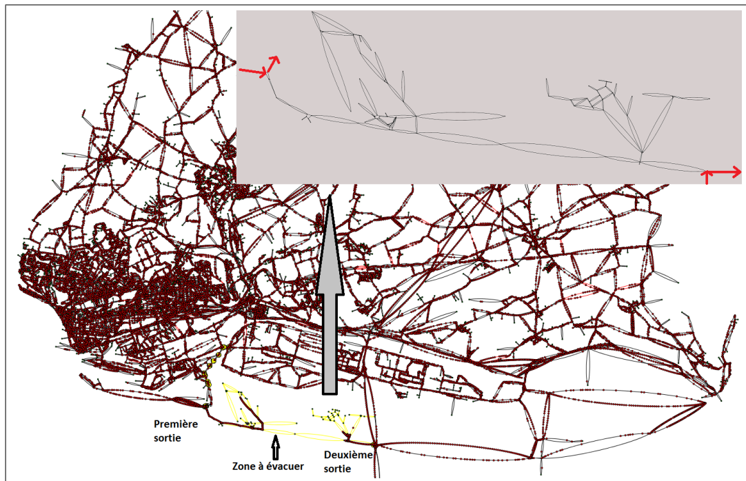
FIGURE 9.16: Évacuation en cours d'une communauté ayant une interface avec la mer et 2 liens vers l'extérieur. La somme des capacités des liens sortants est de 9 véhicules. 45 000 véhicules circulent dans tout le graphe. Les liens inter-communautaires sont colorés en rouge. La communauté à évacuer est agrandie; les liens en rouges correspondent à ses entrées et sorties.
