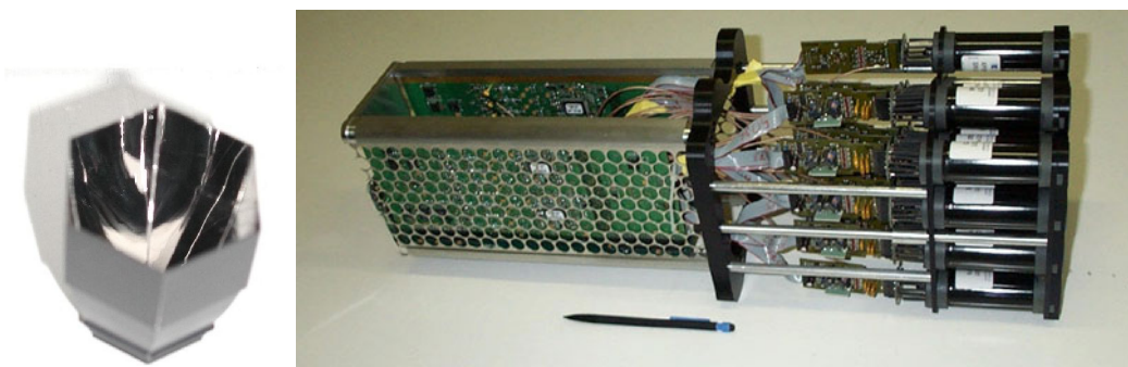
FIGURE 6.7 – Image de gauche : Photographie d'un cône de Winston. Image de Droite : Photographie d'un tiroir contenant 16 PM et l'électronique associée.
