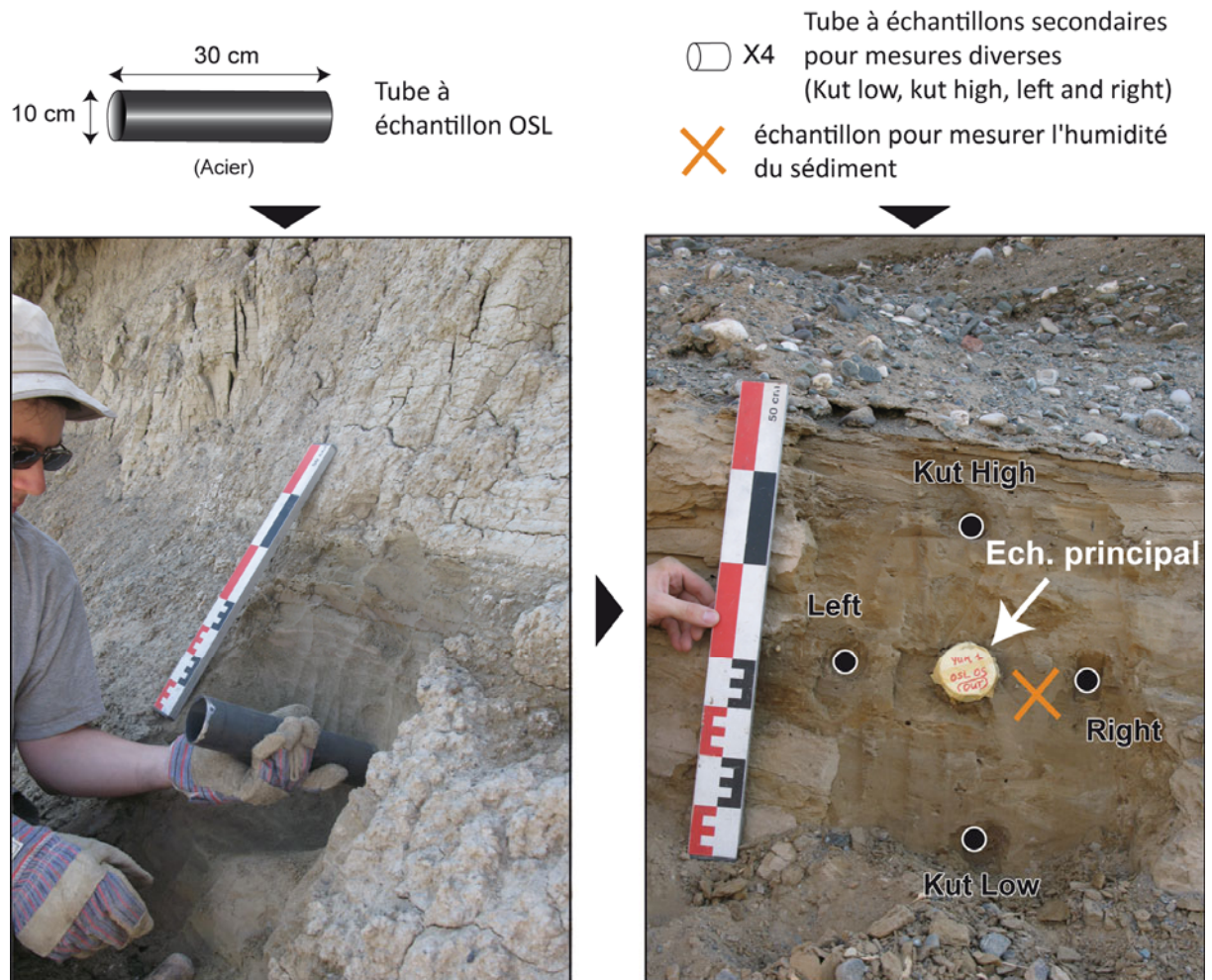
Figure 4-7. Protocole d'échantillonnage pour l'OSL
