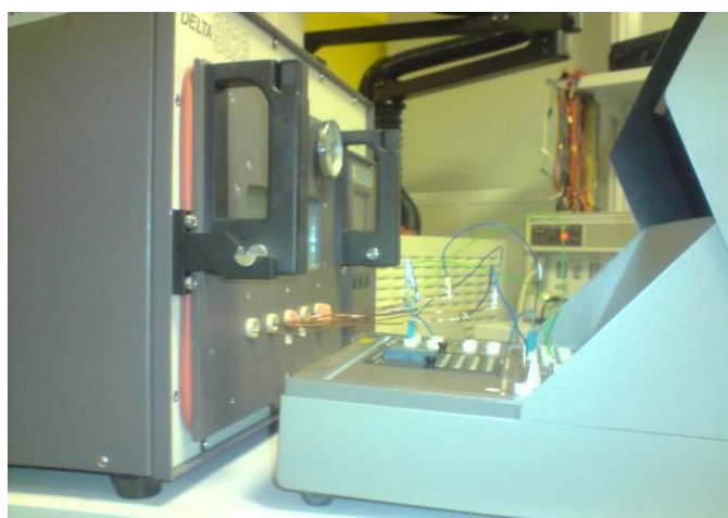
Fig III.13 Les connexions entre le composant dans l'étuve à gauche et la boîte de connexion du HP4142.
