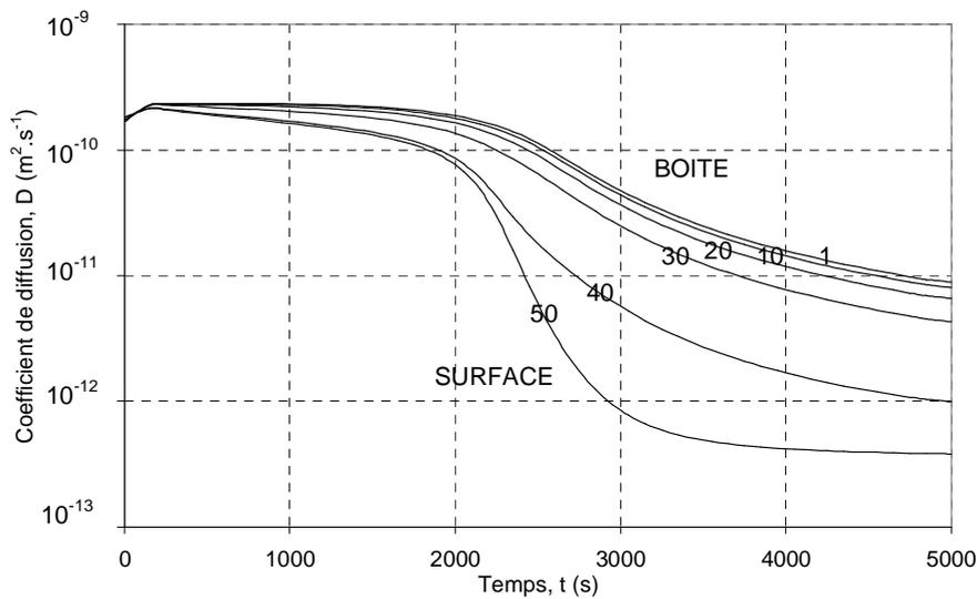
**Figure 3-39 : Essai de simulation en convection ( $T_{\text{air}} = 55^{\circ}\text{C}$ ,  $v_{\text{air}} = 2,8 \text{ m.s}^{-1}$ )**
