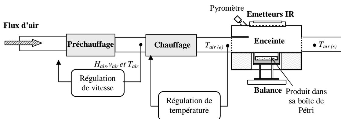
Figure 2-16 : Schéma de principe du pilote de séchage
