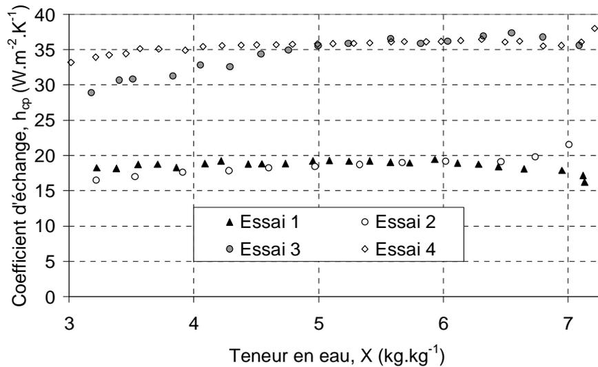
Figure 2-30 : Coefficient de convection en surface du produit
