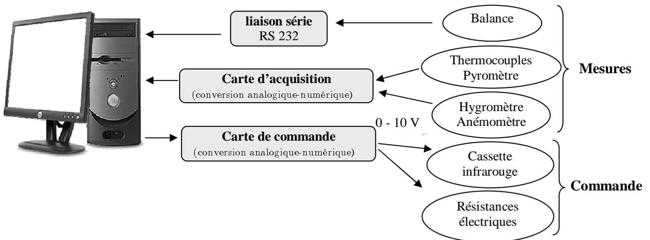
**Figure 2-20 : Système d'acquisition et de commande**
