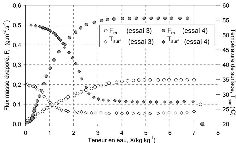
**Figure 2-23: Influence de la température d'air ( $v_{\text{air}} = 2,8 \text{ m.s}^{-1}$ )
