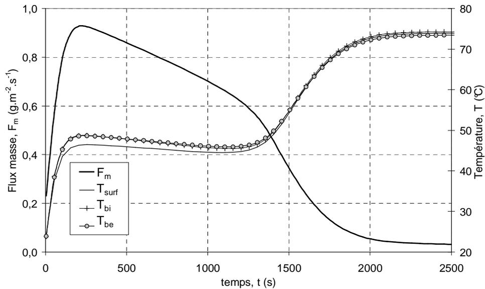
**Figure 3-40 : Simulation de cinétiques de séchage pour un essai en infrarouge**
