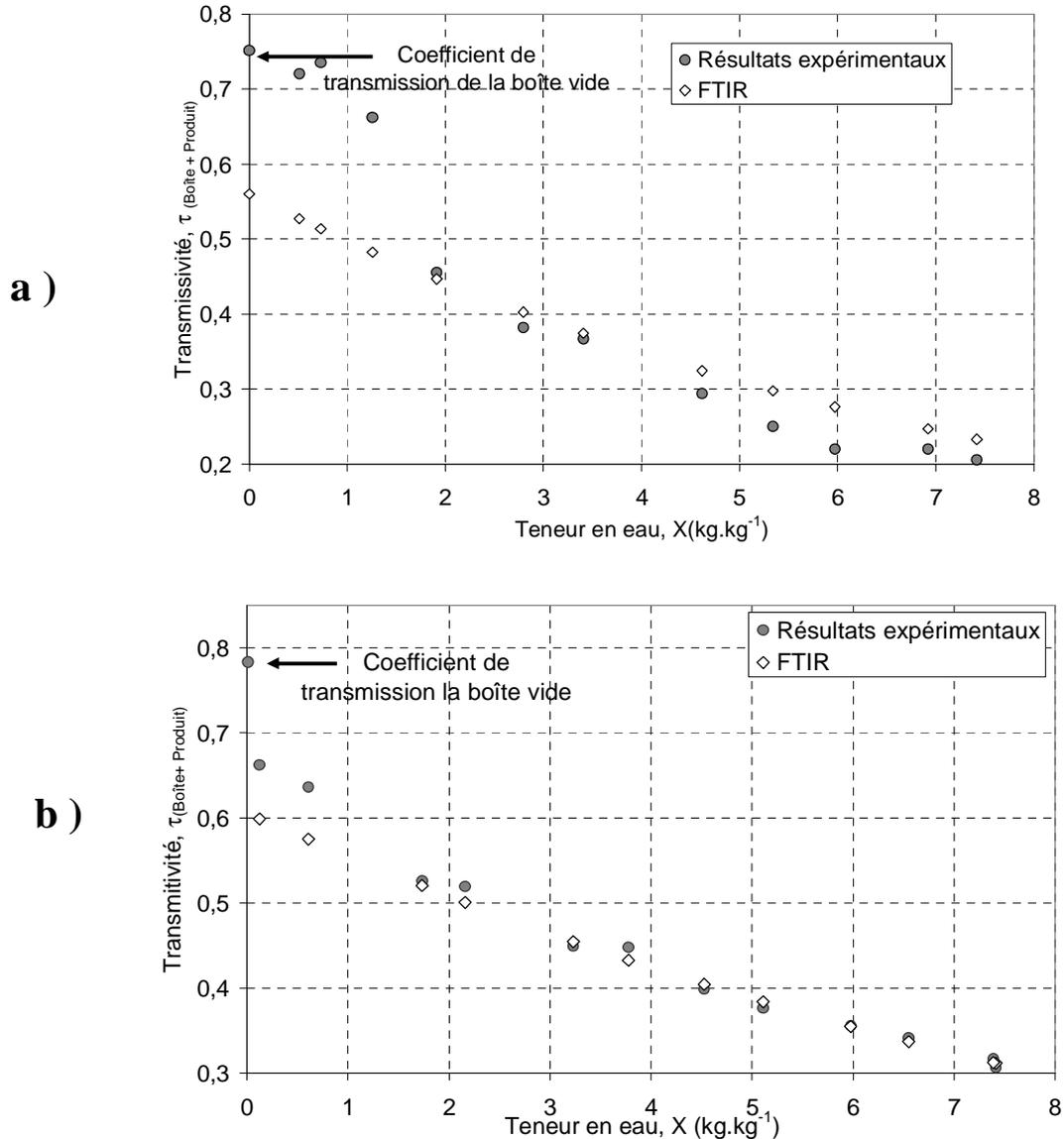
**Figure 2-36 : Evolution du coefficient de transmission du produit étudié**
