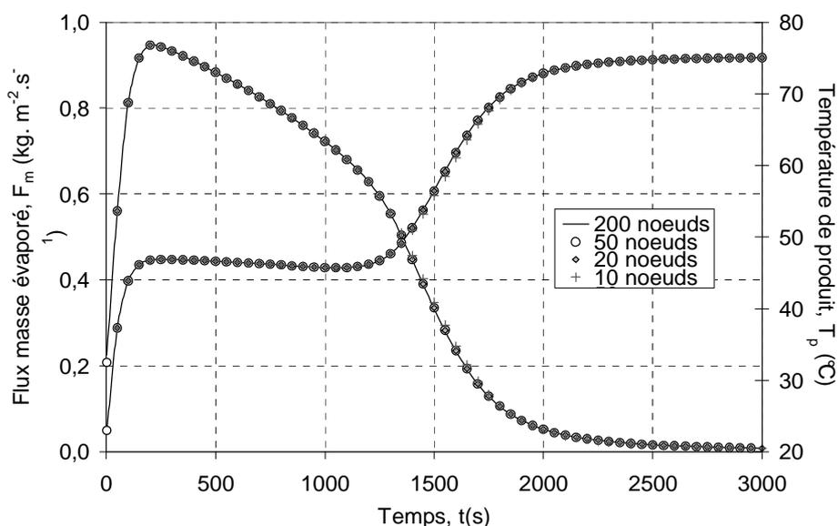
**Figure 3-43 : Influence du maillage (Approche barycentrique) lors d'un essai infrarouge ( $T_{\text{air}} = 35^{\circ}\text{C}$ ,  $v_{\text{air}} = 1 \text{ m}\cdot\text{s}^{-1}$  et  $P_{\text{IR}} = 3,7 \text{ kW}\cdot\text{m}^{-2}$ )**
