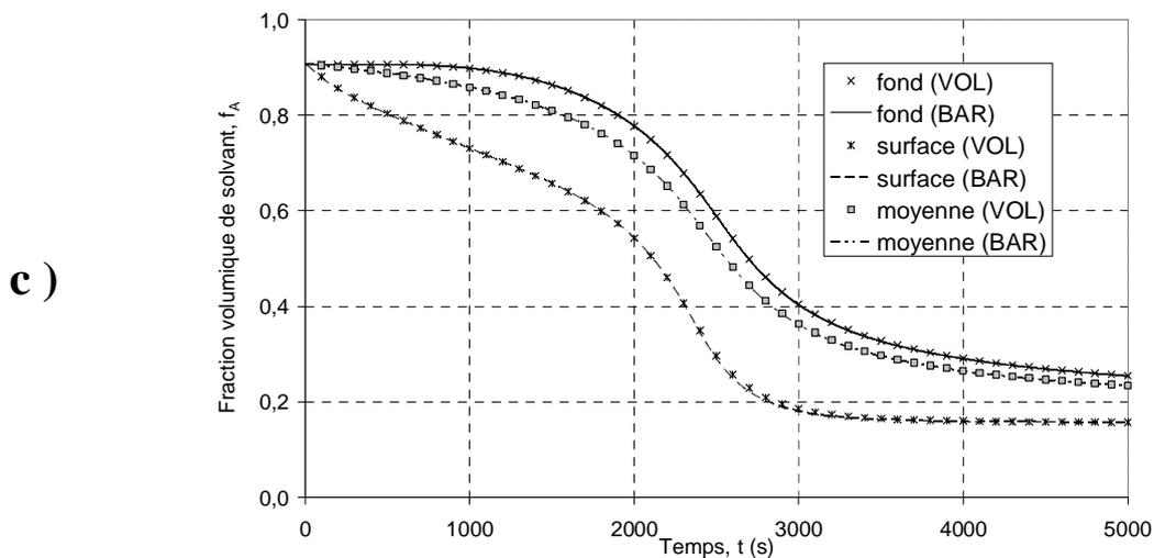
**Figure 3-41 : Confrontation de l'approche volumique et barycentrique pour un essai en convection ( $T_{\text{air}} = 55^{\circ}\text{C}$ ,  $v_{\text{air}} = 2,8 \text{ m.s}^{-1}$ ,  $H_{\text{air}} = 20\%$ )**
