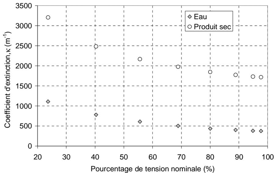
**Figure 2-35 : Coefficients d'extinction**
