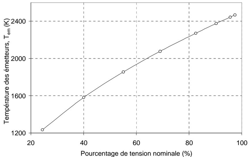
**Figure 2-33 : Température d'émission des émetteurs infrarouges**
