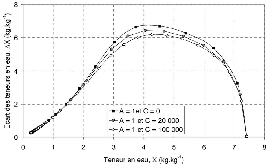
Figure 4-67 : Evolution de l'écart entre la teneur en eau en surface et au fond de la boîte en fonction de la teneur en eau moyenne pour différentes pondérations
