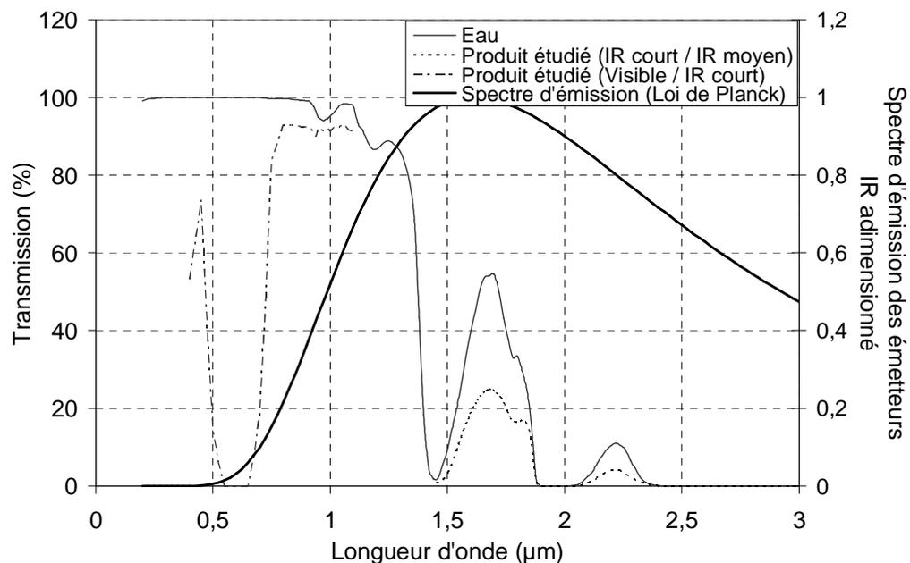
**Figure 2-34 : Spectre d'émission des émetteurs et spectre d'absorption du produit industriel**
