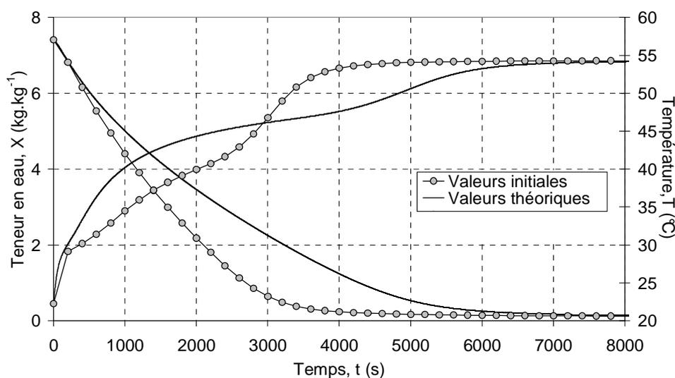
Figure 3-47 : Minimisation sur un cas théorique ( $T_{\text{air}} = 55^{\circ}\text{C}$  et  $v_{\text{air}} = 2,8 \text{ m.s}^{-1}$ )
