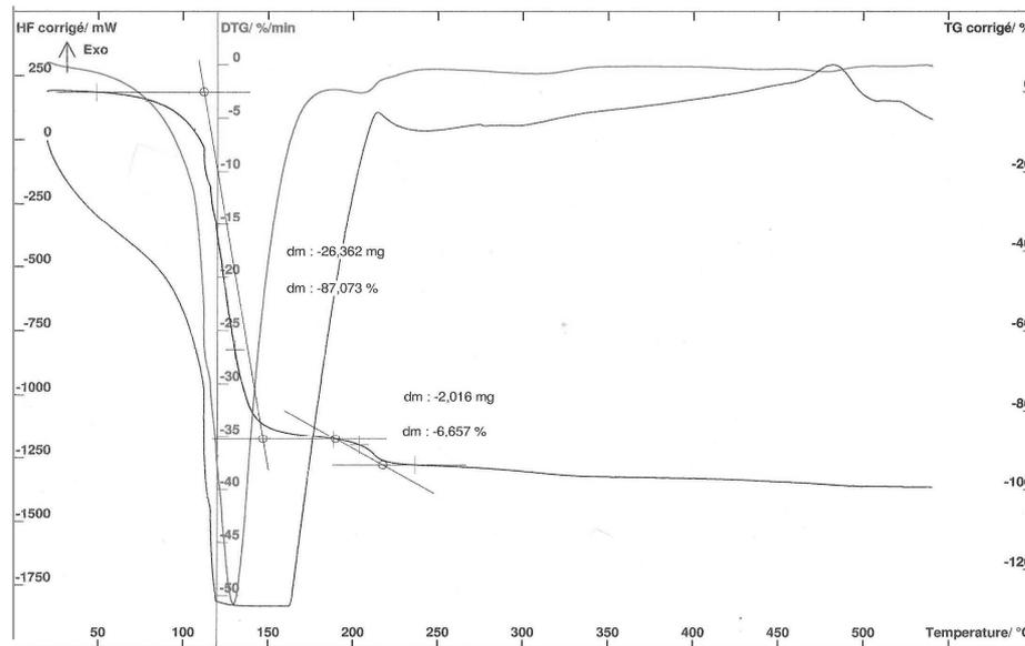
Figure 2-5 : Analyse thermogravimétrique du produit étudié
