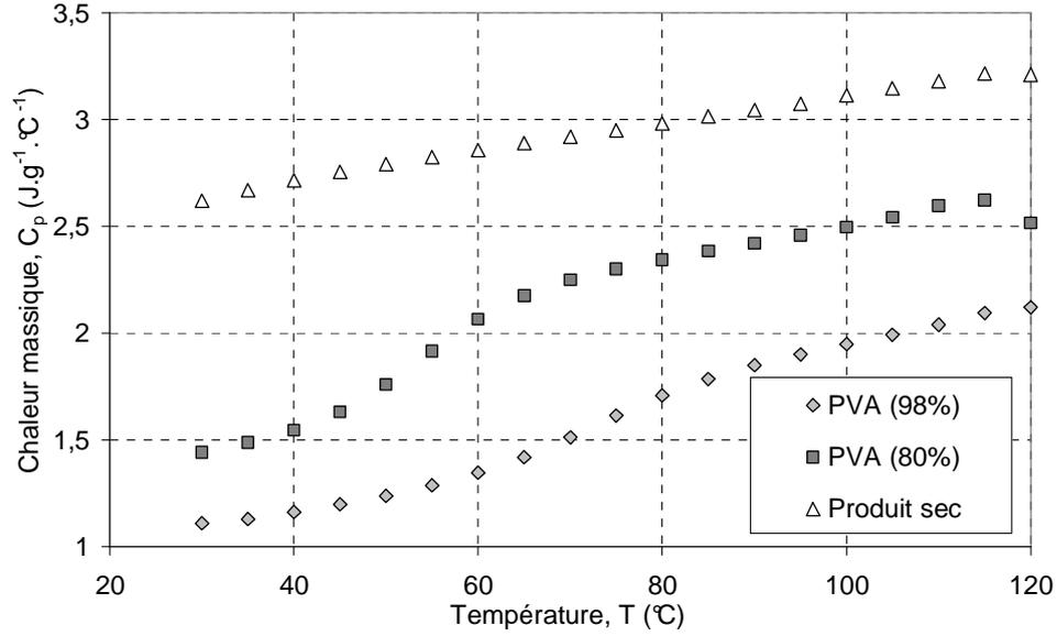
**Figure 2-9 : Chaleur massique en fonction de la température**
