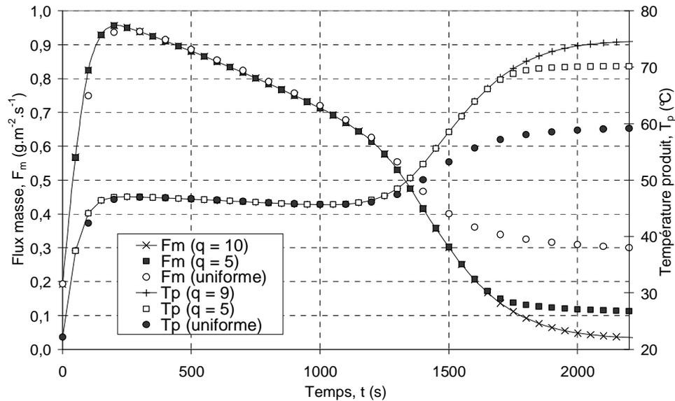
**Figure 3-45 : Influence de la déformation du maillage (Approche volumique, 50 nœuds) lors d'un essai infrarouge ( $T_{\text{air}} = 35^{\circ}\text{C}$ ,  $v_{\text{air}} = 1 \text{ m.s}^{-1}$  et  $P_{\text{IR}} = 3,7 \text{ kW.m}^{-2}$ )**
