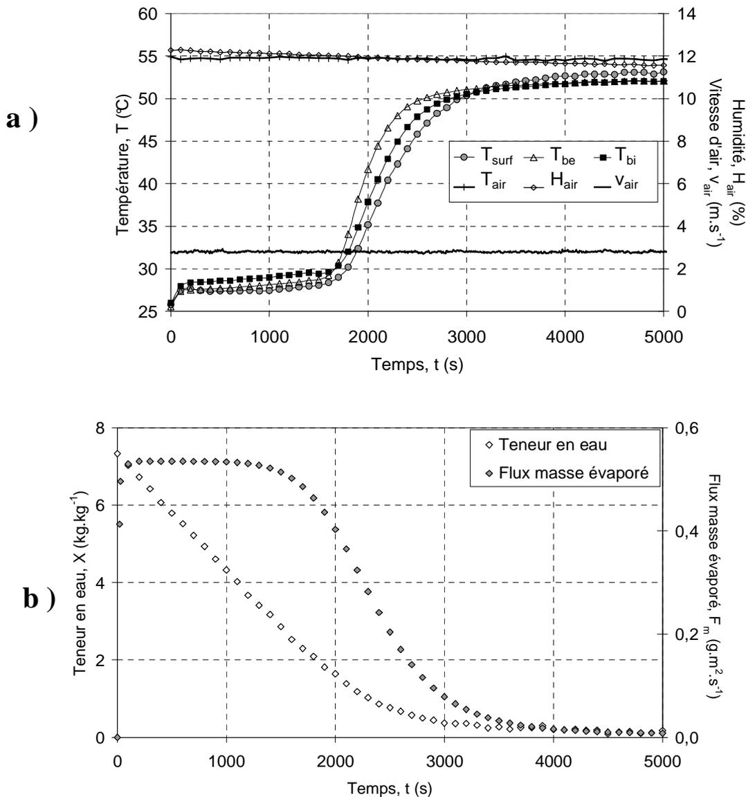
**Figure 2-21 : Evolution des températures (a) et de la perte de masse (b) lors de l'essai convectif N°4 ( $v_{air} = 2,8 m \cdot s^{-1}$  et  $T_{air} = 55^{\circ}C$ )**
