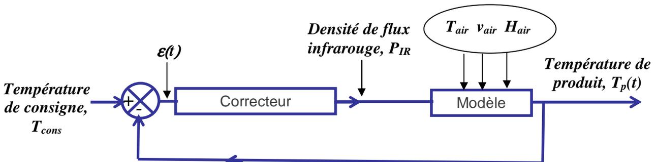
Figure 4-59 : Régulation en boucle fermée
