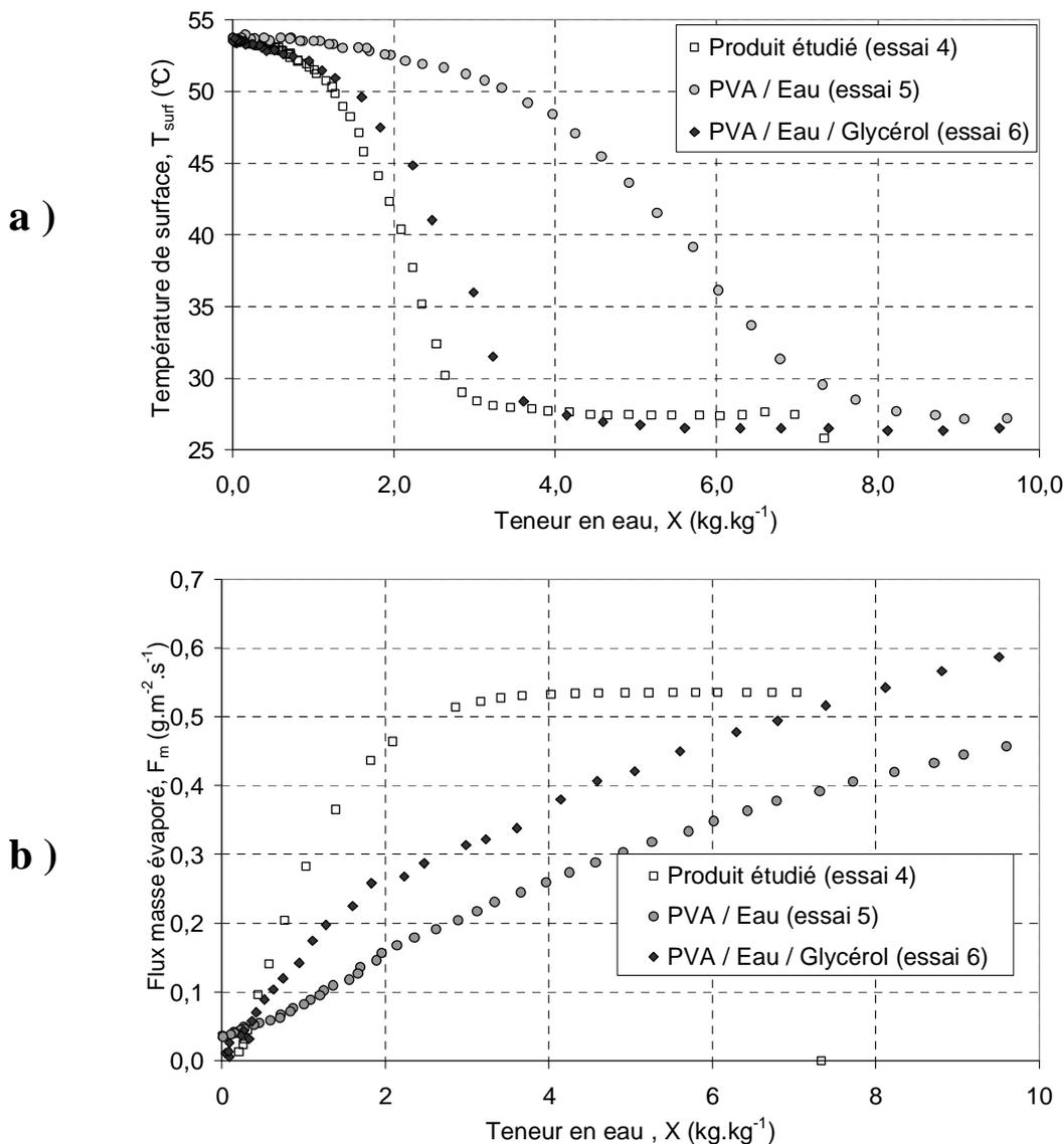
Figure 2-24 : Evolution de la températures de surface (a) et du flux d'eau évaporé (b) de différents mélanges lors d'essais convectifs ( $v_{\text{air}} = 2,8 \text{ m.s}^{-1}$  et  $T_{\text{air}} = 55^{\circ}\text{C}$ )
