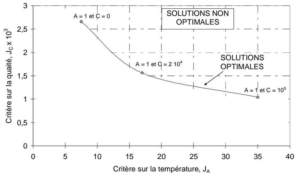
Figure 4-68 : Représentation des solutions optimales (fonction de Pareto)
