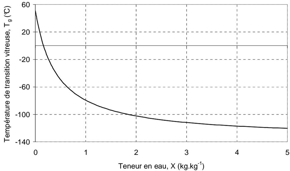
**Figure 2-7 : Température de transition vitreuse du produit en fonction de la teneur en eau**
