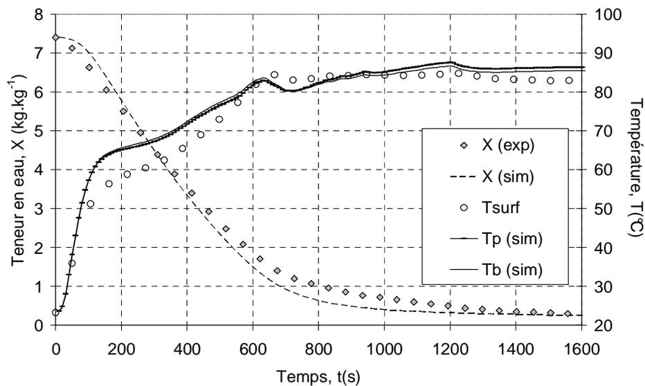
Figure 4-69 : Confrontation entre les réponses expérimentales et simulées avec la loi de commande obtenue pour  $A = 1$  et  $C = 2 \cdot 10^4$
