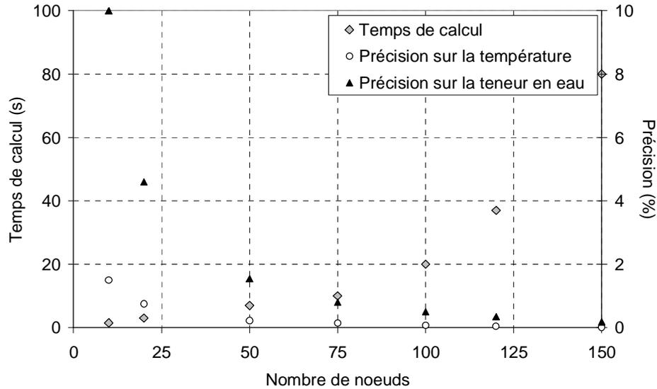
**Figure 3-44 : Temps de calcul et précision du modèle basé sur l'approche barycentrique
