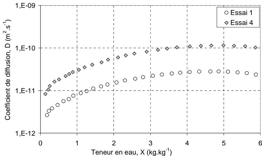
**Figure 2-31 : Evolution du coefficient de diffusion effectif lors des essais N°1 ( $v_{air} = 1 \text{ m.s}^{-1}$ ,  $T_{air} = 35^\circ\text{C}$ ) et N°4 ( $v_{air} = 2,8 \text{ m.s}^{-1}$ ,  $T_{air} = 55^\circ\text{C}$ )**
