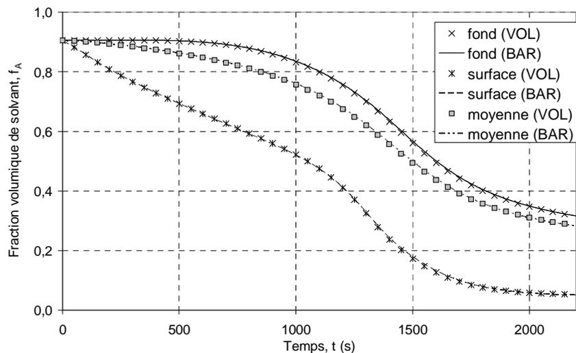
**Figure 3-42 : Simulation des cinétiques de séchage (a), des teneur en eau (b) et des fractions volumiques de solvant (c) lors d'un essai en infrarouge ( $T_{\text{air}} = 35^\circ\text{C}$ ,  $v_{\text{air}} = 1 \text{ m.s}^{-1}$  et  $P_{\text{IR}} = 3,7 \text{ kW.m}^{-2}$ )**
