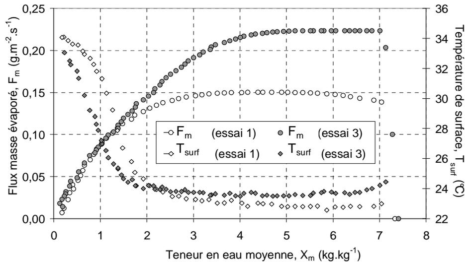
**Figure 2-22 : Influence de la vitesse d'air ( $T_{\text{air}} = 35^\circ\text{C}$ )
