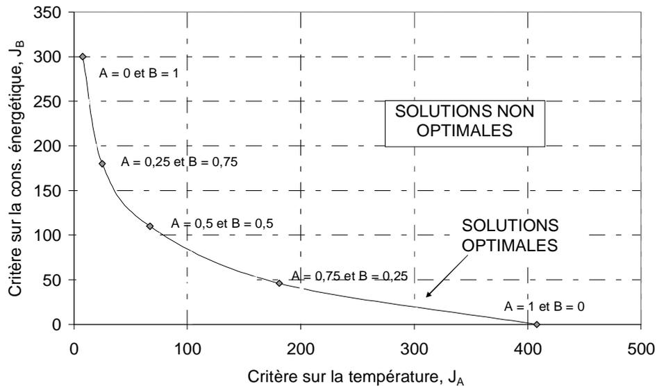
Figure 4-64 : Représentation des solutions optimale (courbe de Pareto)
