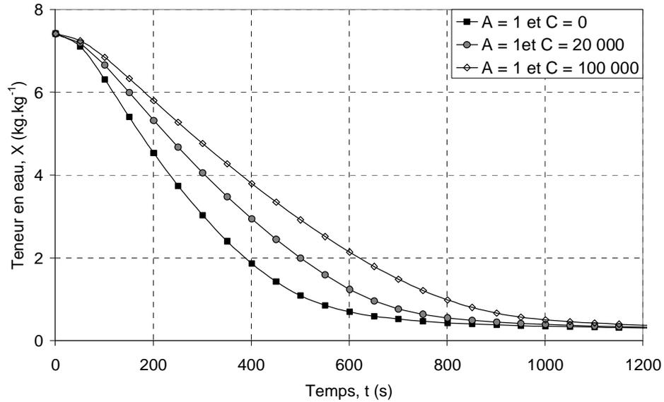
**Figure 4-65 : Compromis entre le temps de séchage et la teneur en eau superficielle**
