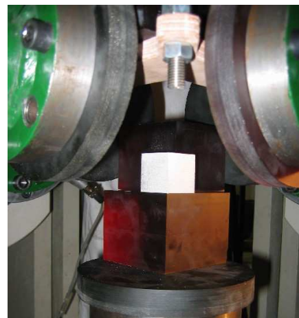
(b) sistema após compactação e recuo dos atuadores – nota-se a boa funcionalidade do dispositivo e a amostra do material compactado nas três direções
