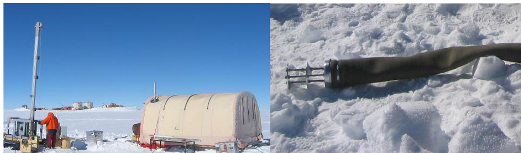
FIGURE 2.9 – Photographies du site de pompage, avec le carottier de forage et la tente, à gauche, et de la tête inférieure du manchon, à droite
