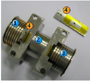
Fig 61:: Chambre de neutralisation avec jeux de déviateurs montés
