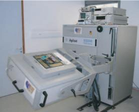
Figure 2.4 – Équipement de test automatique (ATE).
