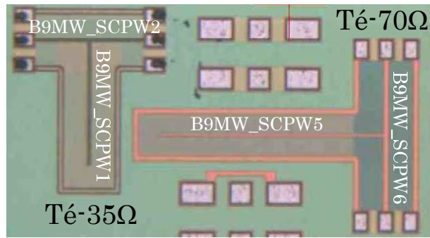
Figure 4.2 : Photographie des deux té : stubs en circuit ouvert placés en parallèle de la ligne principale.
