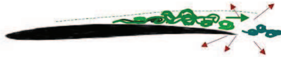
Figure II-2 : schéma illustrant la génération du bruit propre des profils (d'après M. Roger – ECL)
