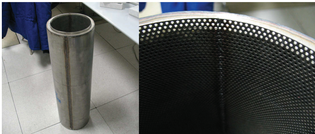
Figure V-8 : silencieux inséré en amont de la turbine
