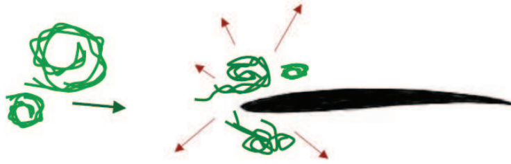
Figure II-1 : schéma illustrant la génération de bruit par l'interaction de la turbulence avec un profil (d'après M. Roger – ECL)
