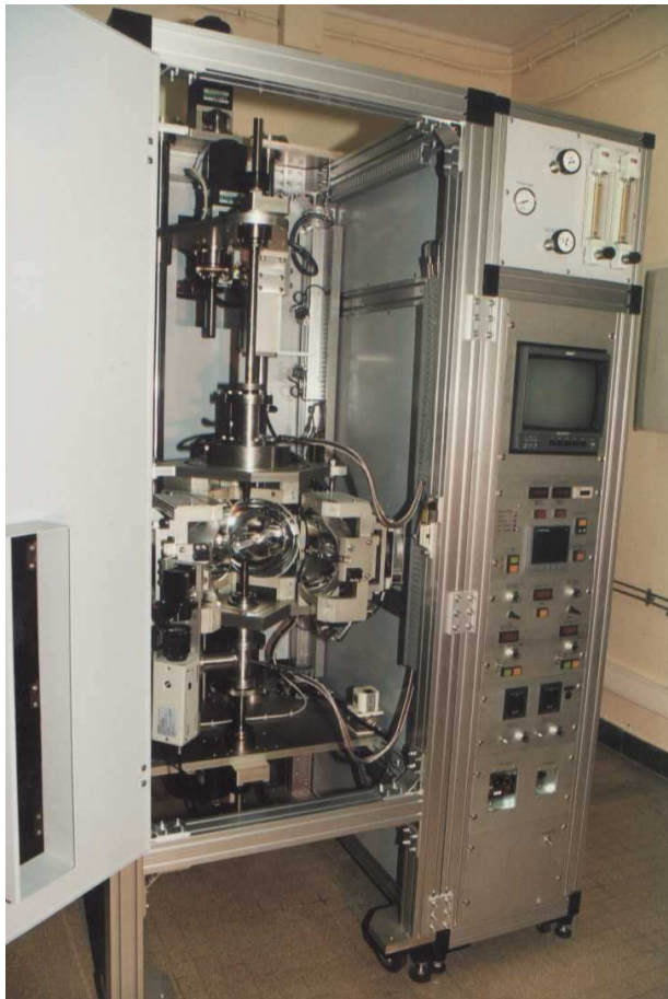
Figure 8: à gauche, vue générale du four à image CSI FZ-T-4000-H-II-PP, à droite, vue de l'enceinte; les flèches indiquent les mouvements introduits lors de la croissance.
