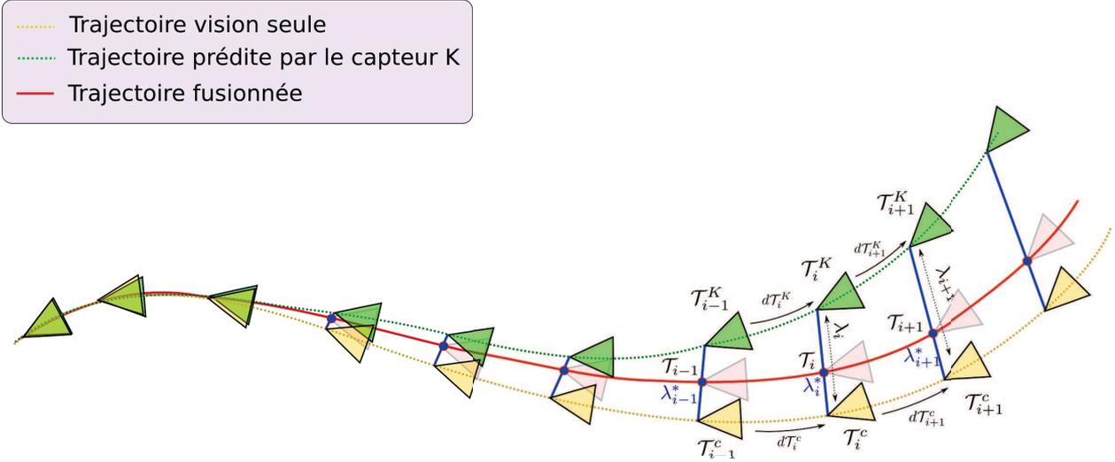
FIGURE 5.2 – Illustration de la fusion de la trajectoire estimée par un algorithme de *Structure-from-Motion* séquentiel avec les observations d'un second capteur  $k$  et par l'estimation dynamique des coefficients de pondération  $\lambda_{i \in [1..N_m]}$ .
