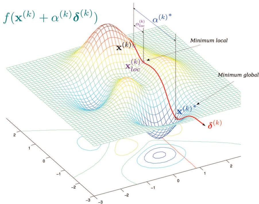
FIGURE 2.1 – Recherche linéaire : estimation de la norme  $\alpha$  du déplacement  $\delta$ . Exemple sur une fonction objectif à deux variables. Deux longueurs sont proposées ( $\alpha_{loc}$  et  $\alpha^*$ ), qui correspondent à deux solutions :  $\mathbf{x}_{loc}$  est un minimum local et  $\mathbf{x}^*$  est le minimum global dans la direction du déplacement  $\delta$ .
