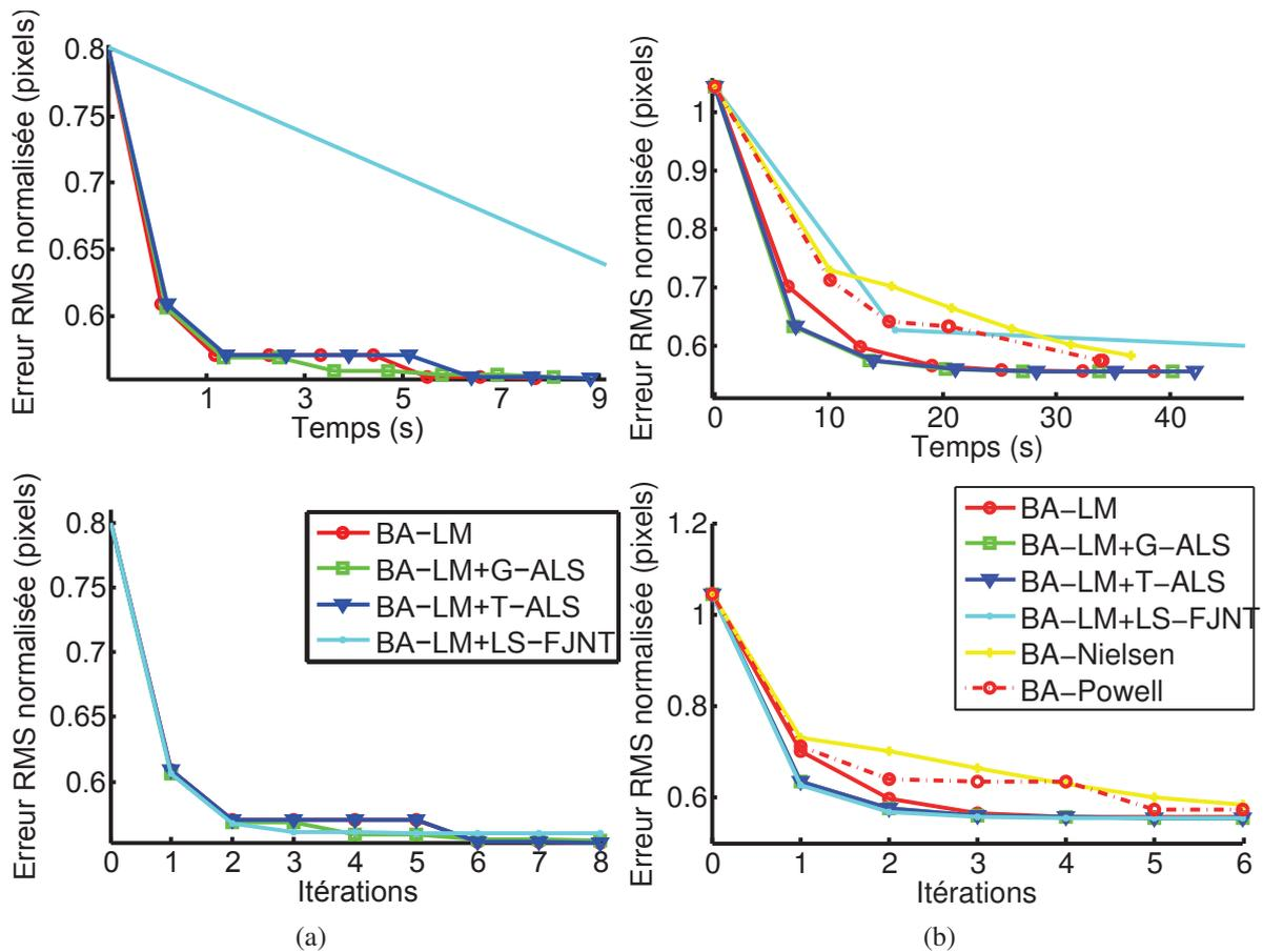
FIGURE 4.14 – Évolution du RMS (pixels) par rapport au temps de calcul (en haut) et par rapport aux itérations (en bas), pour des ajustements locaux (a) et globaux (b).
