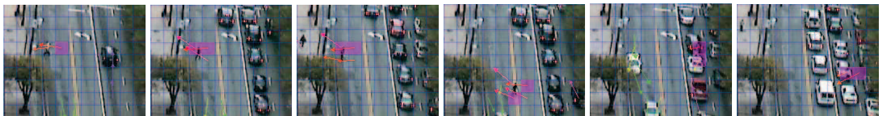
FIGURE 5.20 – Exemples de détection sur la séquence routière Peachtree. Différents piétons traversent en dehors des passages cloutés. Certains piétons se faufilent au travers de voiture à l’arrêt.
