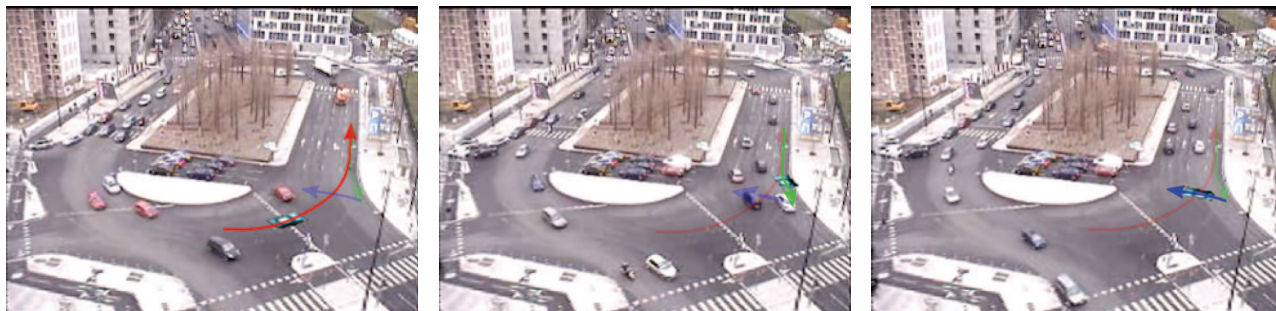
FIGURE 5.5 – Exemples de réalité augmentée générée pour constituer une base de test d’évènements. La trajectoire est définie par une spline par morceaux, le long de laquelle une texture est incrustée en respectant une transformation homographique permettant de prendre en compte la perspective de la scène.
