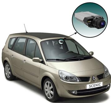
FIGURE 5.3 – Positionnement de la caméra dans le véhicule
