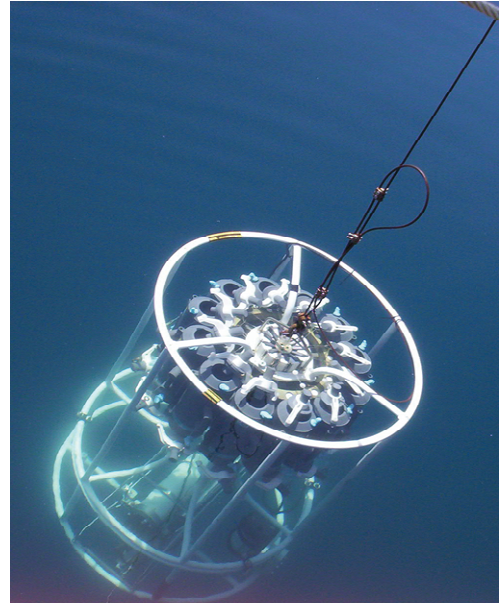
Figure 27: Bouteilles Niskin attachées et lancées dans la mer sur le site DYFAMED
