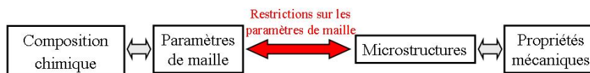
FIGURE 8.0.1 – Relation indirecte entre la composition chimique d'un AMF et ses propriétés mécaniques.
