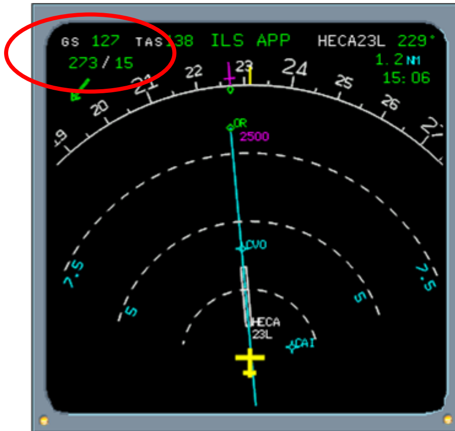
Figure 2 : Exemple de ND de l'A330
