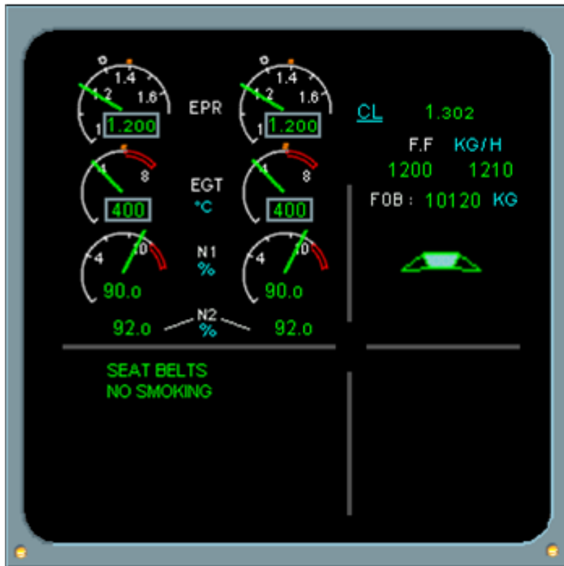
Figure 4 : Ecran ECAM A330 montrant les paramètres de conduite des moteurs
