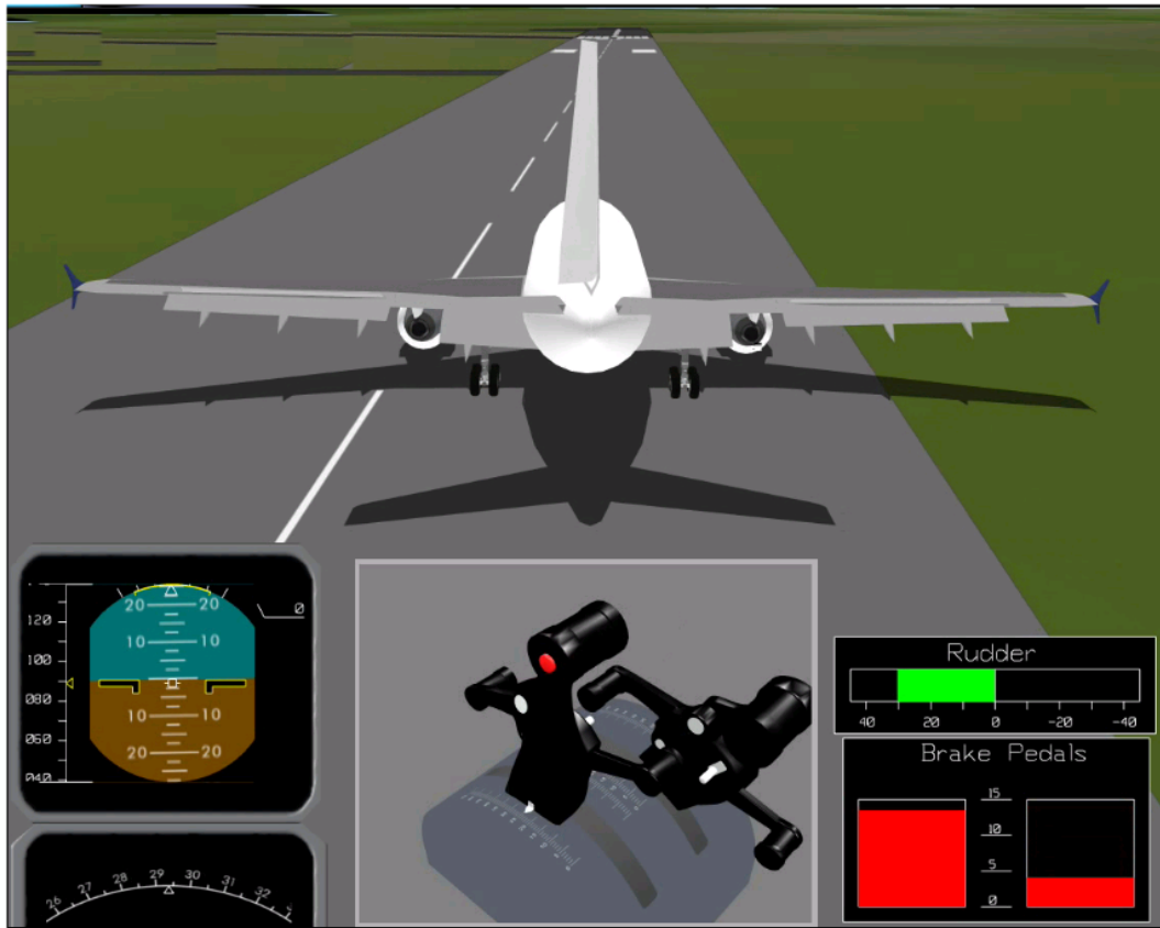
Figure 40 : Début de déplacement intempestif du levier de poussée gauche
