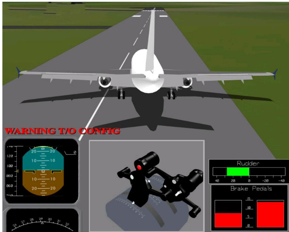
Figure 41 : Apparition de l'alarme « configuration »
