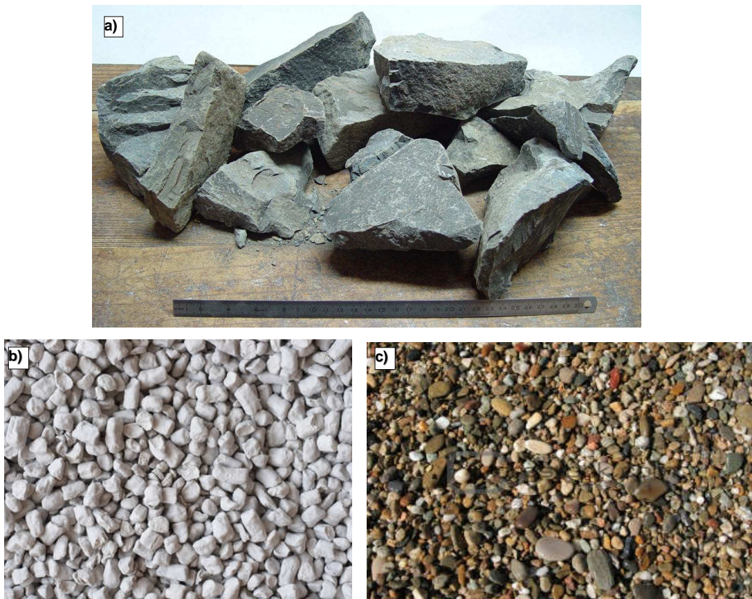
Figure IV-19 : a) Basalte concassé, b) chamotte calcinée, c) galets roulés.
